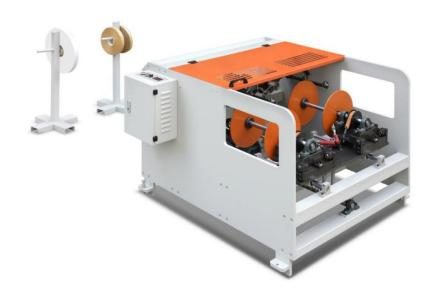
本机主要配套高速半自动圆绳手把机和纸袋机。 可高速制造纸绳,为手把机提供纸绳。 该机以窄幅卷筒纸为原料,通过机器各轴的高速旋转,将纸捻成绳状并保持在纸绳卷筒中。 用户可以调整纸绳的直径,以满足不同的生产需要。
