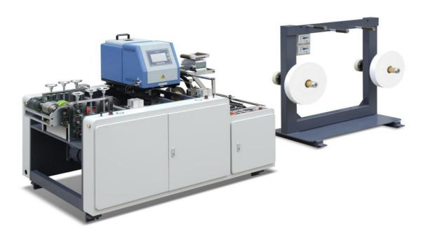
本机主要配套半自动纸袋机。 它可以用纸绳快速生产纸把手,在后续生产中,可以将手把人工粘贴在没有把手的纸袋上,制成手提纸袋。 本机以两卷窄窄的纸卷和一根纸绳为原料,将碎纸片和纸绳粘在一起,逐渐切断形成纸手把。 此外,该机还具有自动计数和上胶功能,可大大提高用户后续加工操作的效率。
