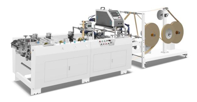
本机是我司最新研发的新一代直角扁绳手挽机,经过我司不断的创新和研发,速度快230-300pcs/min,操作简单将已分切好的四卷纸通过复杂的工艺,一次成型完成扁绳和扁手挽的制作,并可配合上水胶系统和流水线能迅速提升生产速度,适合大批量生产。
